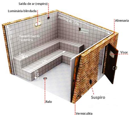
Para um bom banho de sauna, com temperaturas em torno de 45°C; é importante que o ambiente tenha isolamento Térmico. Além da metragem cúbica ser compatível com o equipamento.
