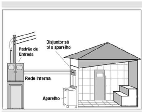
Providencie uma rede elétrica exclusiva e individual para o aparelho de sauna nas suas respectivas dimensões de cabos e disjuntores. (tabela abaixo).
